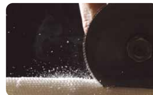
当社ガラスファイバー製キャスト 粒子サイズ:幅15~20 \mu m
