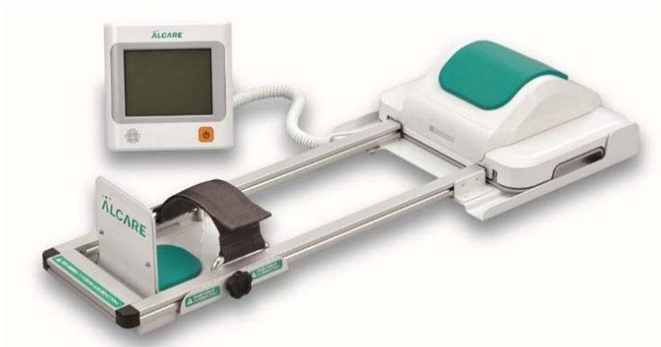
訓練機能付下肢筋力測定器『ロコモスキャン®』 (アシストフレーム取り付け済)
